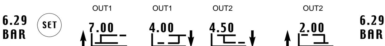
**Exemplo:** Comutação OUT1 em modo standard (NA - Normal aberto), comutação OUT2 em modo standard (NF - Normal fechado).
